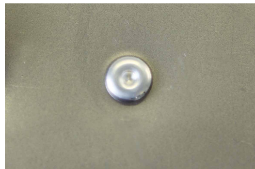
RÉSULTAT DE POSE D'UN RIVET FLOW-FORM
