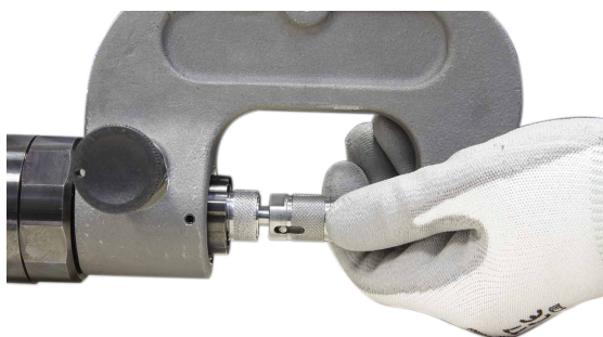
Привинтите насадку, идущую в комплекте с плечом.
