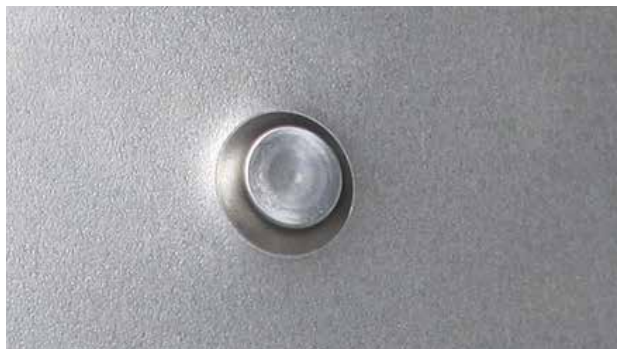
RÉSULTAT DE POSE D'UN RIVET AUTO-PERÇANT
