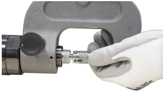
Schrauben Sie den Verlängerungsadapter an den Arm.
